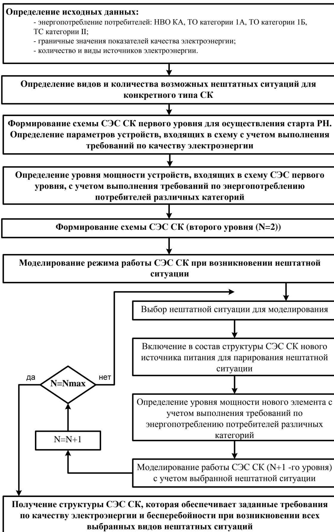
Малюнок 9.1.20 - Блок-схема методу формування структури СЕС СК
