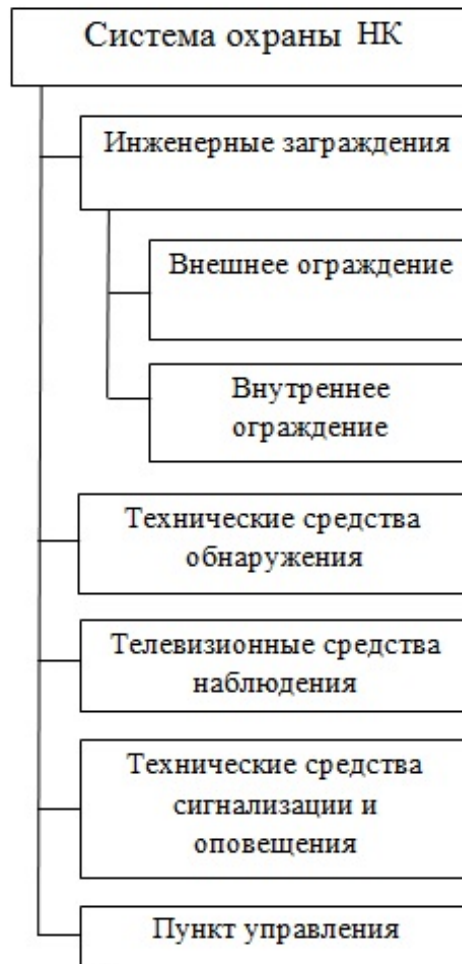
Малюнок 9.7.1 - Попередня структурна схема системи охорони об'єктів НК
