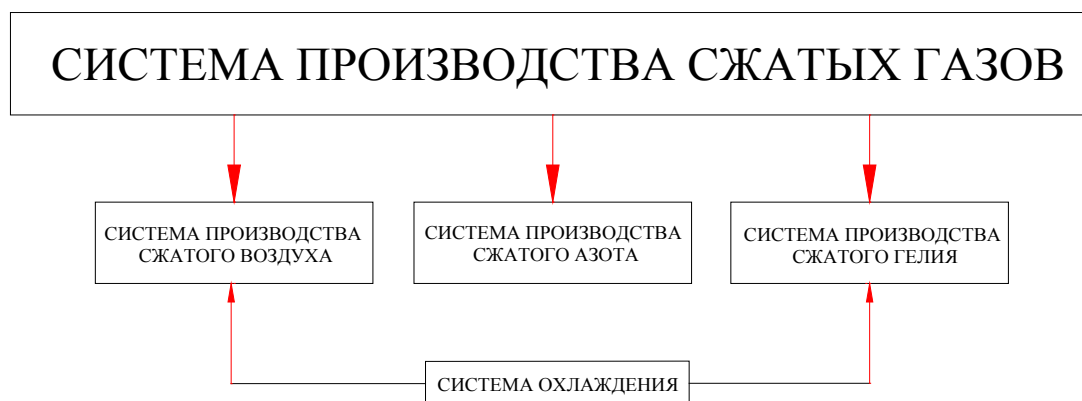
Малюнок 10.15.1 - Структурна схема системи виробництва стислих газів
