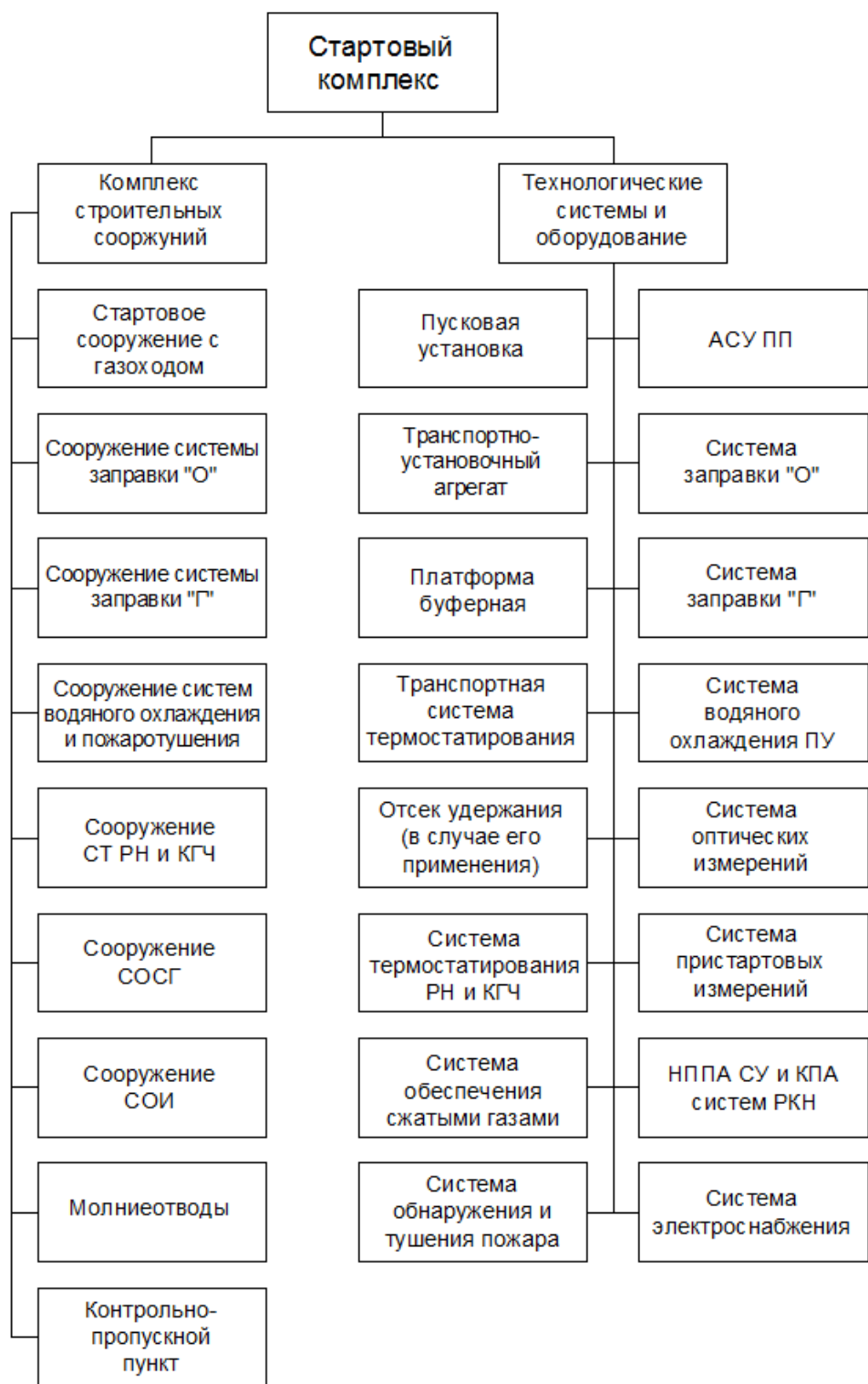
Малюнок 4.1.1 - Структурна схема СК для варианту горизонтальної зборки РКП
