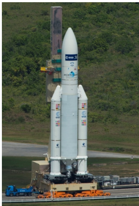
Малюнок 3.4.2 - Транспортування РКП у вертикальному положенні за допомогою спеціальної платформи до точки старту
