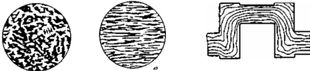
Рисунок 3.2. – Зміна зерен, структури металу при пластичній деформації.
