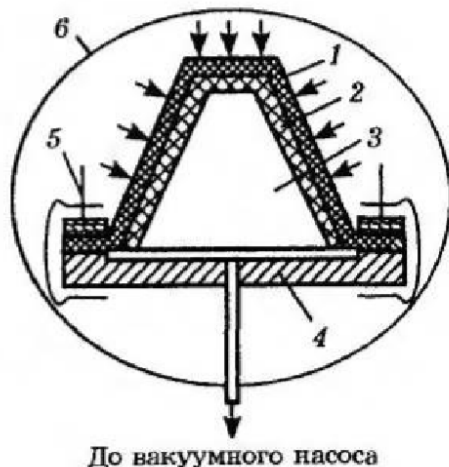
Рис. 9.5 Схема вакуумно-автоклавного формування
