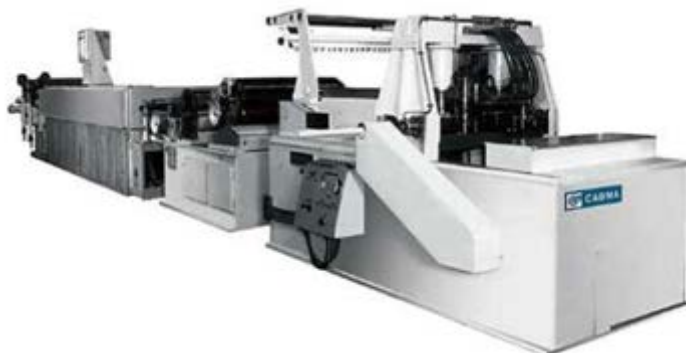
Рисунок 13.14. – Верстат автомат для виготовлення пакетів стільникових заповнювачів АСП-1000
