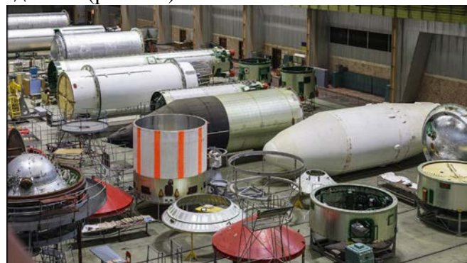
б - металеві відсіки ракет-носіїв у цеху збирання ПО «Південний машинобудівний завод»
