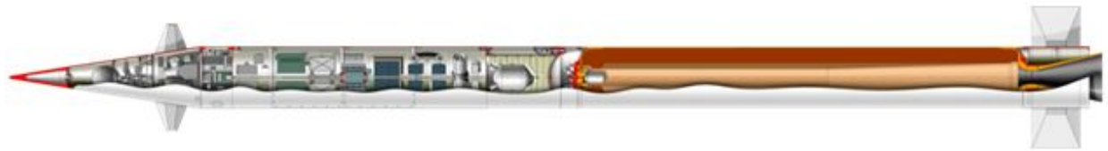
Рисунок 4.1. Метеорологічна ракета «Метео-3» – одноступінчаста твердопаливна керована ракета з відделяємою у польоті головною частиною
