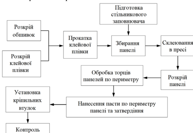
Рисунок 13.15 – Схема технологічного процесу виготовлення плоских заготовок багатощарових панелей зі стільниковим наповнювачем
