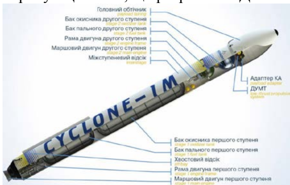
а - ракета-носіє «Циклон-1М»
