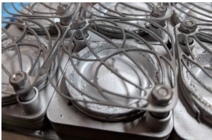
Рисунок 1.22 Фото повністю еродованого катоду вакуумно-дугового двигуна на металевій плазмі МРТ4.3-001 після 2,2 млн. імпульсів
