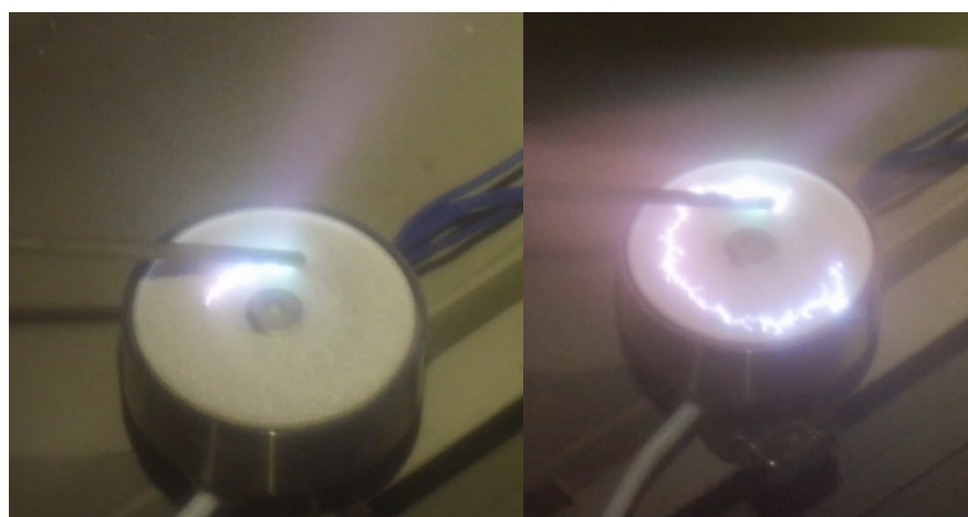
Рисунок 3.7. Робота в вакуумній камері стенду експериментального електродугового реактивного двигуна на металевій плазмі з дисковим катодом
