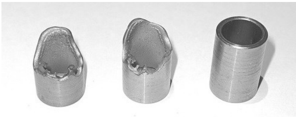
Рисунок 1.19 Трубчаті титанові катоди після експлуатації (ліворуч) та катод, який не був в експлуатації (праворуч)
