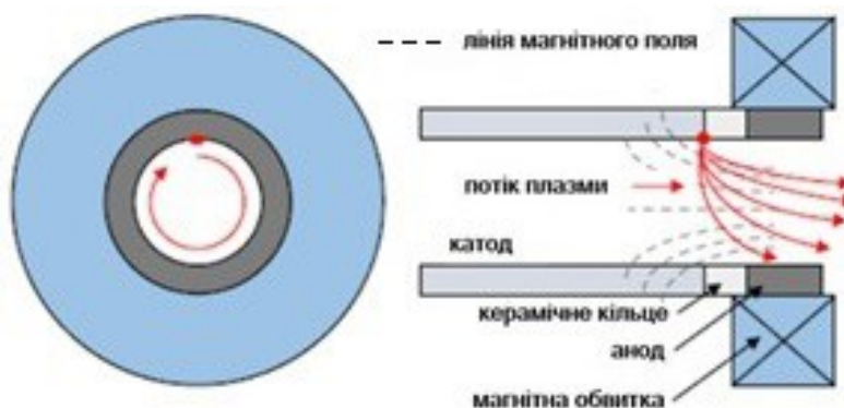
Рисунок 1.7 Вид спереду (ліворуч) та вид збоку (праворуч) на двигун \mu CAT з кільцевим електродом. На зображенні зліва показано круговий рух
