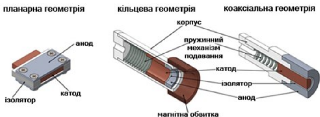
Рисунок 1.6 Найпоширеніша геометрія вакуумно-дугового двигуна: планарна (ліворуч), кільцева (посередині) і коаксіальна схеми розташування електродів (праворуч).
