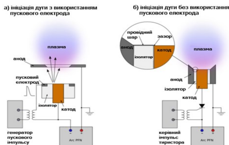
Рисунок 1.16. Принципова схема безтригерного запалення дуги. Ліворуч – звичайна система з пусковим електродом. Праворуч – з «безпусковим» запалюванням дуги.
