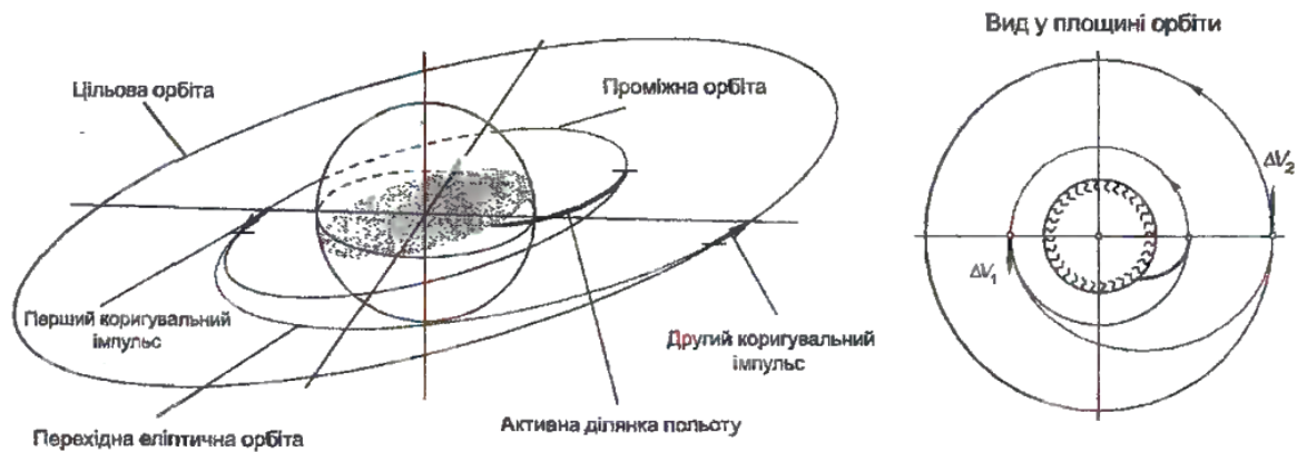
Рис. 4.5. Схема виведення з двохімпульсним компланарним переходом.
