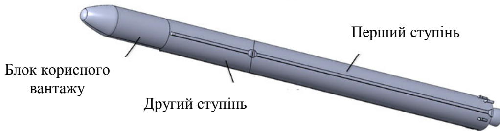
Рис 6.4. Типова схема багатоблокової ракети-носія
