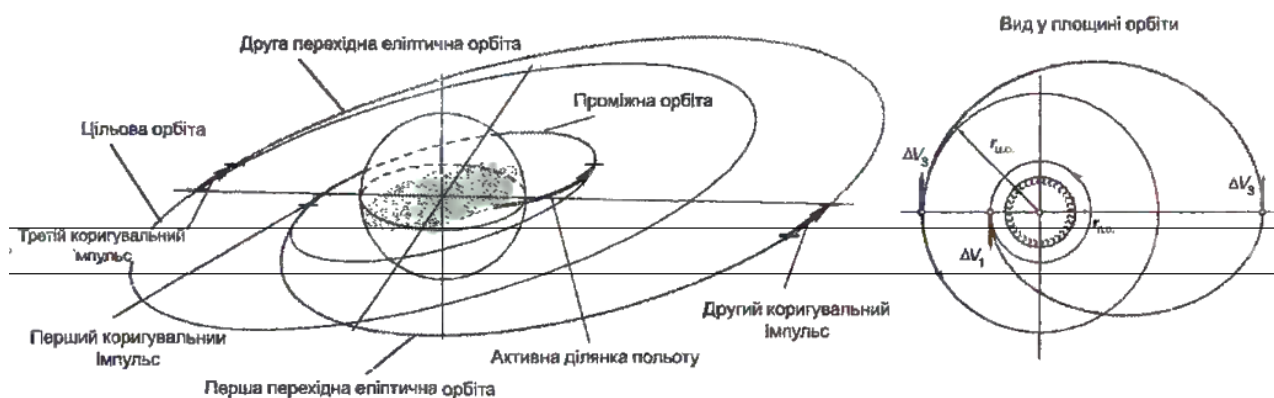
Рис. 4.6. Схема виведення з трьохімпульсним компланарним переходом
