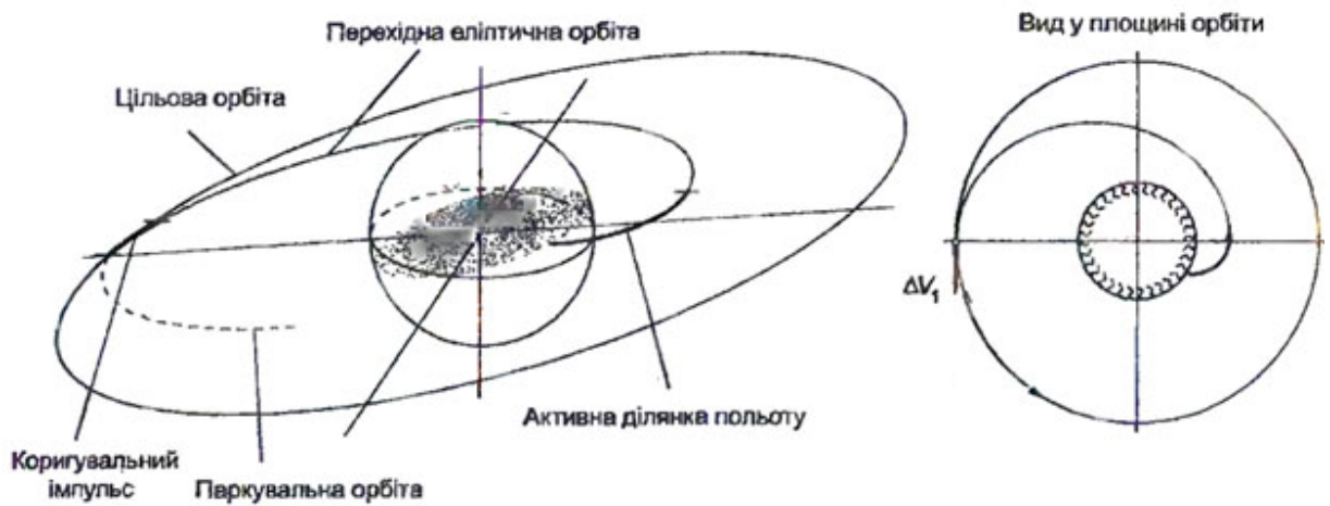
Рис. 4.4. Схема виведення з одноімпульсним компланарним переходом
