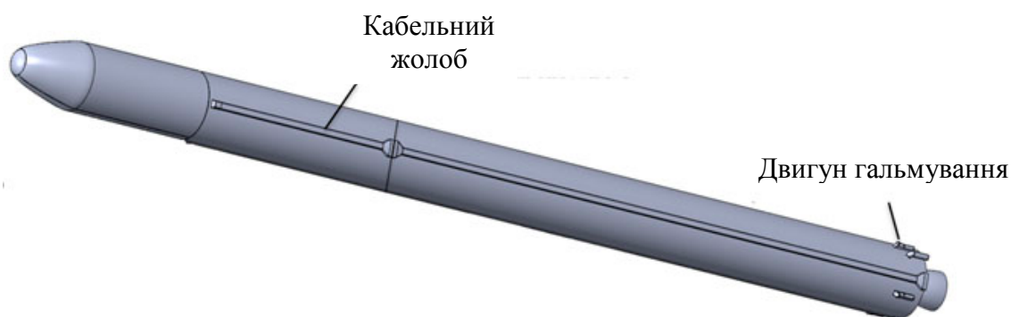
Рис 6.6. Приклад прокладення кабельного жолобу
