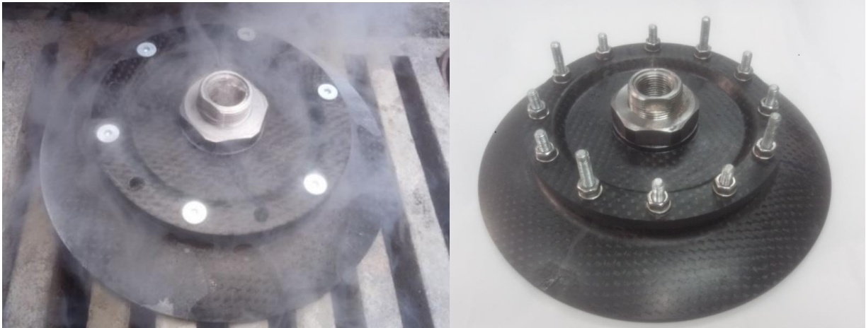
Рисунок 3.35. Дослідний зразок фланцевого з'єднання до та після кріоцикування
