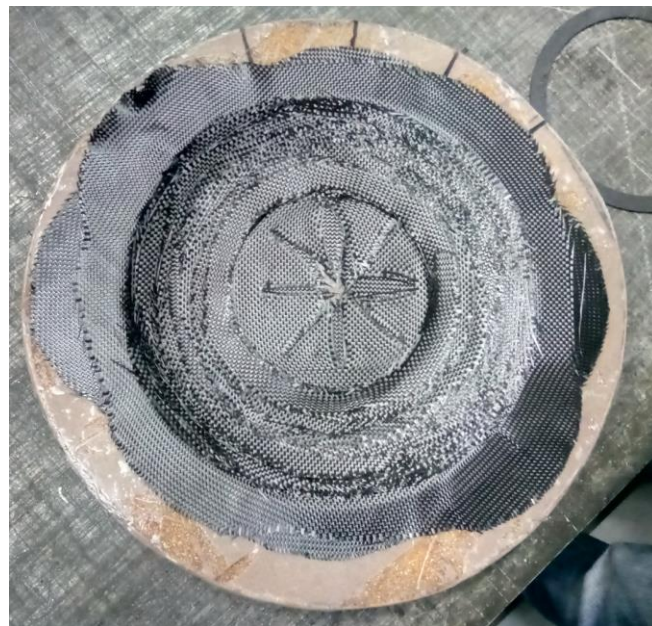
Рисунок 3.26. Форма для виготовлення заготовки фланця
