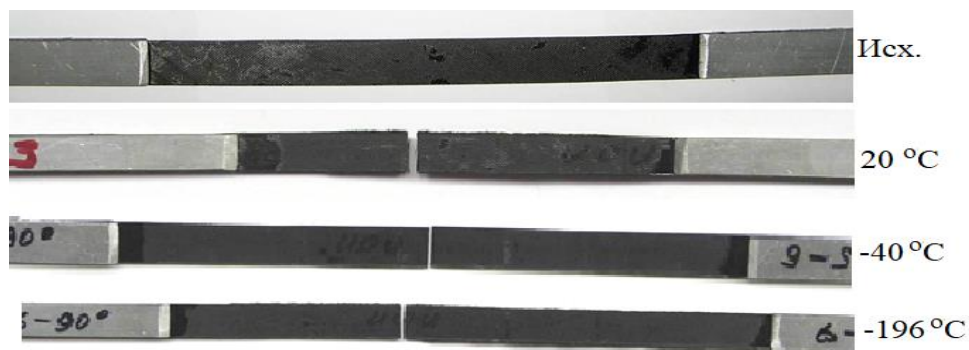
Рисунок 2.9. Зразки вуглепластику до та після випробувань на розтягання в поперечному напрямку при різних температурах
