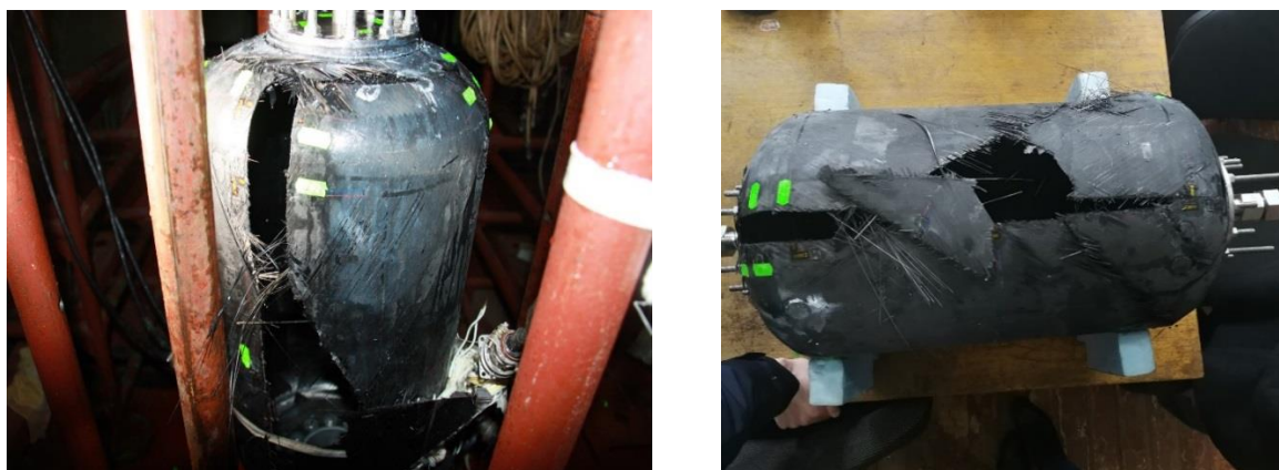
Рисунок 4.24. Конструкція паливного бака після руйнування
