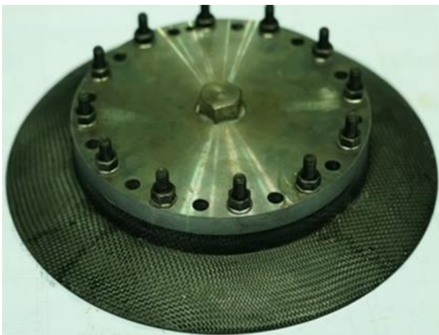
Рисунок 3.33. Фланець до та після випробувань (0-88,72 кгс/см 2 )
