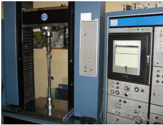
Рисунок 2.1. Універсальна випробувальна машина Instron 1126 трьохточковий вигин дозволила проводити навантаження зразків, безпосередньо занурених у середовище рідкого азоту.
