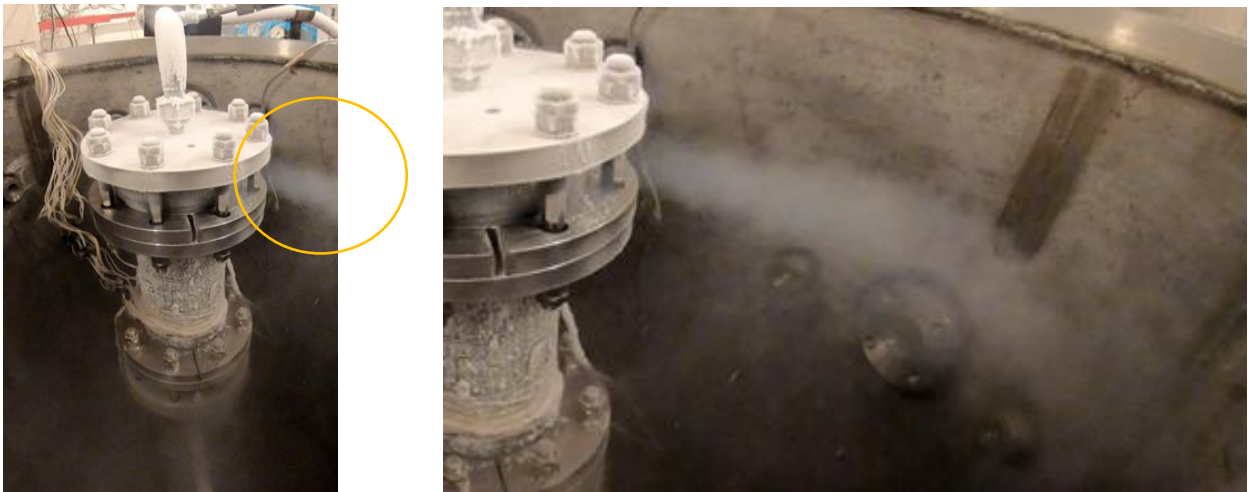
Рисунок 3.14. Втрата герметичності при випробуваннях
