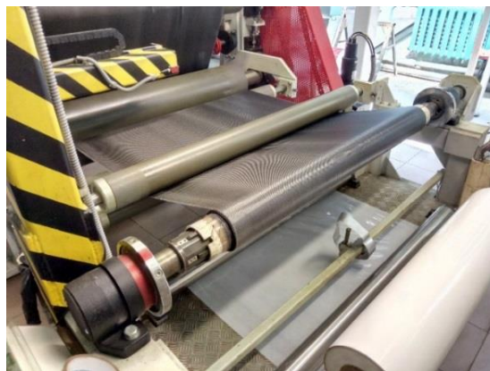
Рисунок 4.7. Процес просочення вуглецевої тканини
