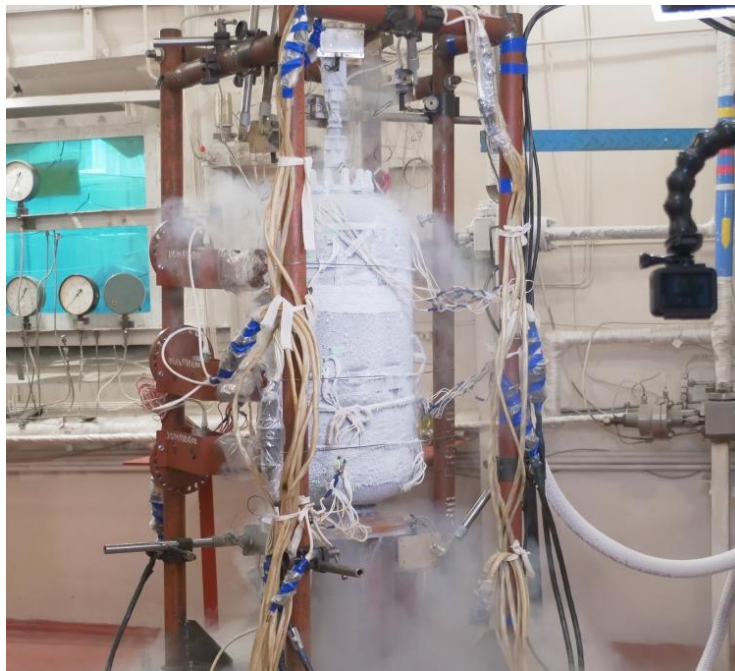
Рисунок 4.21. Процес випробувань конструкції паливного бака надлишковим тиском рідкого азоту
