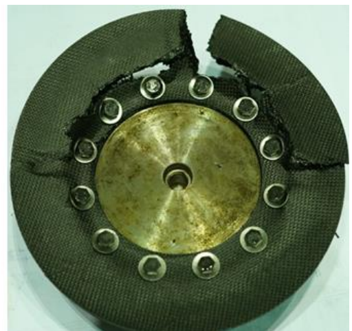
Рисунок 3.33. Фланець до та після випробувань (0-88,72 кгс/см 2 )
