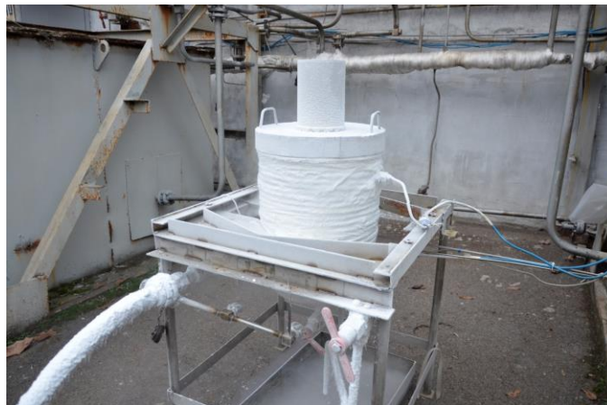
Рисунок 2.6. Установка для випробувань на сумісність матеріалів з компонентами палива
