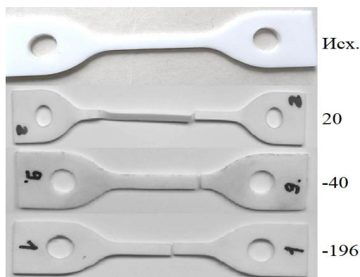
Рисунку 2.13. Зразки фторопласта марки Ф4 у процесі випробувань на розтягання при зазначених температурах
