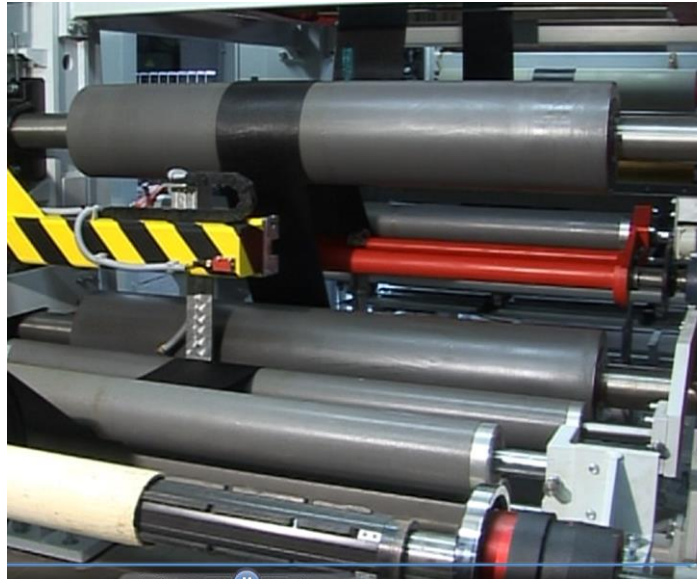
Рисунок 3.25. Процес просочення вуглецевої тканини
