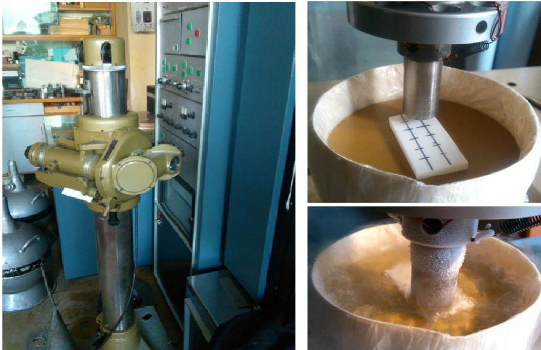
Рисунок 2.5. Катетометр КМ-8 і зразок фторопласта в контейнері з холодоагентом
