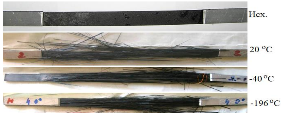
Рисунок 2.8. Зразки вуглепластику до та після випробувань на розтягання в поздовжньому напрямку при різних температурах
