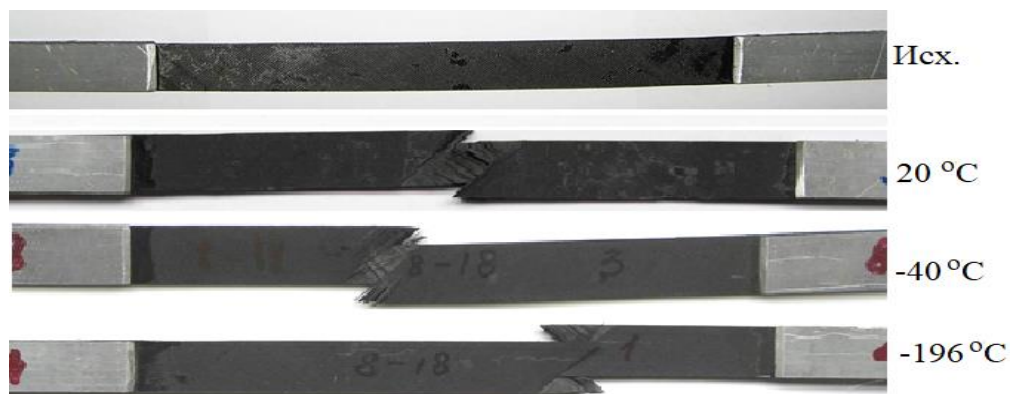
Рисунок 2.10. Зразки вуглепластику до та після випробувань на зрушення при різних температурах
