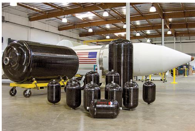
Рисунок 1.6. Криогенні паливні баки з неметалічним лейнером створені на замовлення Scorpius Space Launch Company компанією Microcosm.
