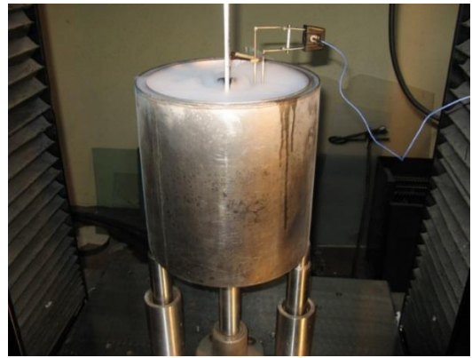
Рисунок 2.1. Універсальна випробувальна машина Instron 1126 трьохточковий вигин дозволила проводити навантаження зразків, безпосередньо занурених у середовище рідкого азоту.
