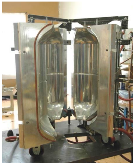
Рисунок 1.13. Розбірна форма для виготовлення полімерного лейнера.
