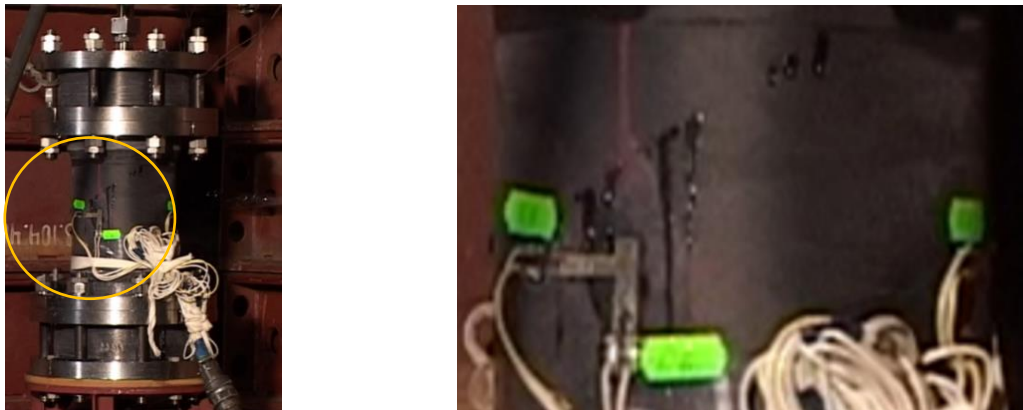
Рисунок 3.13. Втрата герметичності оболонки й місця руйнування трубчастої конструкції товщиною 1мм.
