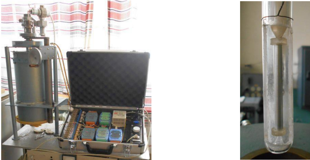
Рисунок 2.3. Зовнішній вигляд дилатометра та зразок зі штовхачем у кварцовому тримачі дилатометра
