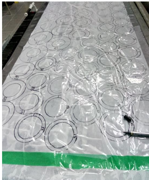
Рисунок 4.9. Процес розмітки й розкрою препрегу
