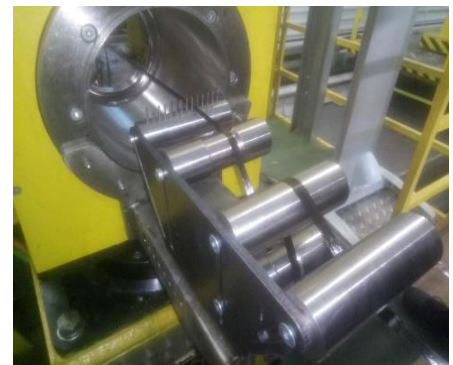
Рисунок 4.11. Графічна схема та вигляд додаткового оснащення в процесі намотування
