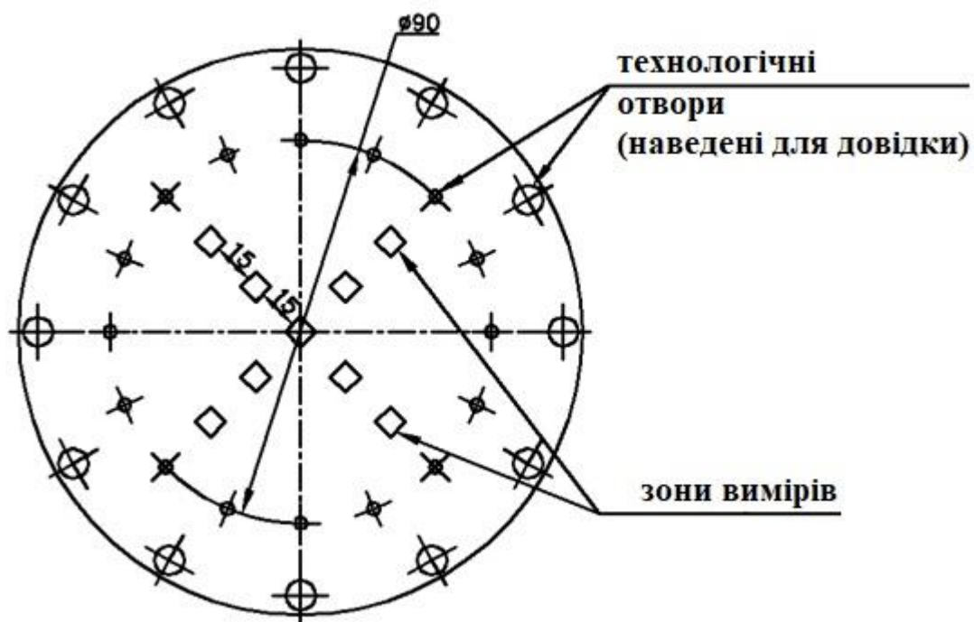
Рис. 2.17. Схема розташування зон вимірів для сіток СРФ 1 і 2 та зразків нових (еталонних) сіток №008
